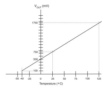
Temperature (°C) =  $\frac{V_{OUT} - 500 \text{ mV}}{10 \text{ mV/}^{\circ}\text{C}}$
